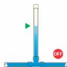
Après l'arrêt, le niveau d'eau monte en raison du manque d'air
