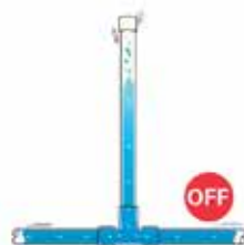
Lors de l'arrêt, des secousses et des turbulences se produisent et on entend les tuyaux cliqueter
